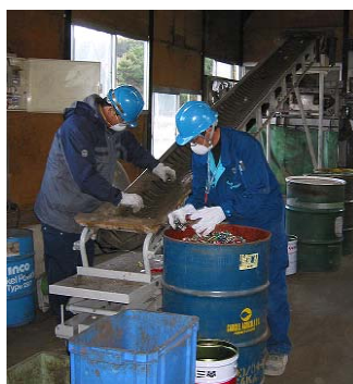
乾電池の破碎作業
