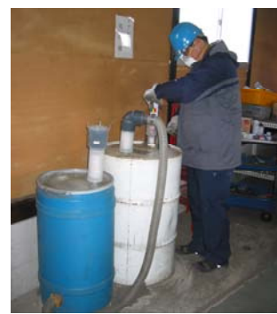
スプレー缶のガス処理
